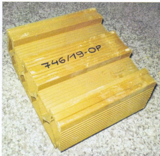
Šuplji blok SRPS B.D1.030:2002-povučen / 245x275x140– 2,89kN I
